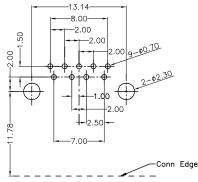
RECOMMENDED PCB LAYOUT(TOP VIEW)
