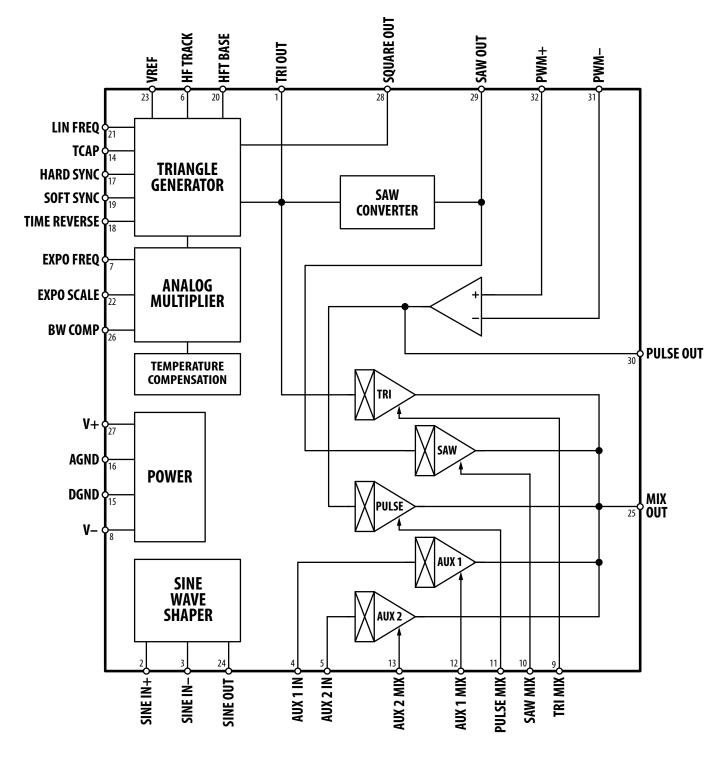
SSI2130 FUNCTIONAL BLOCK DIAGRAM
