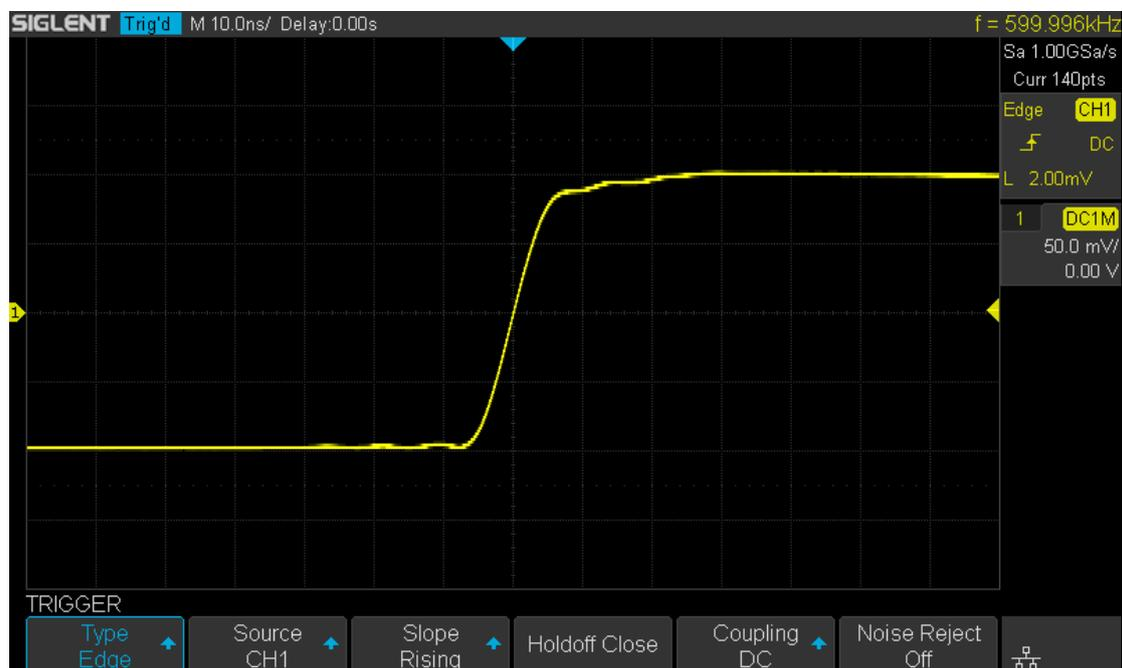
Figure 30 Edge Trigger
