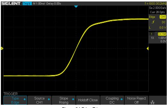
Figure 24 Edge Trigger
