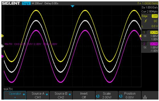
Figure 54 CH1+CH1 Waveform
