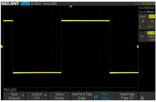
Figure 31 Edge Dropout Trigger
