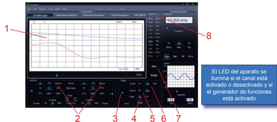
El LED del aparato se ilumina si el canal está activado o desactivado y si el generador de funciones está activado
