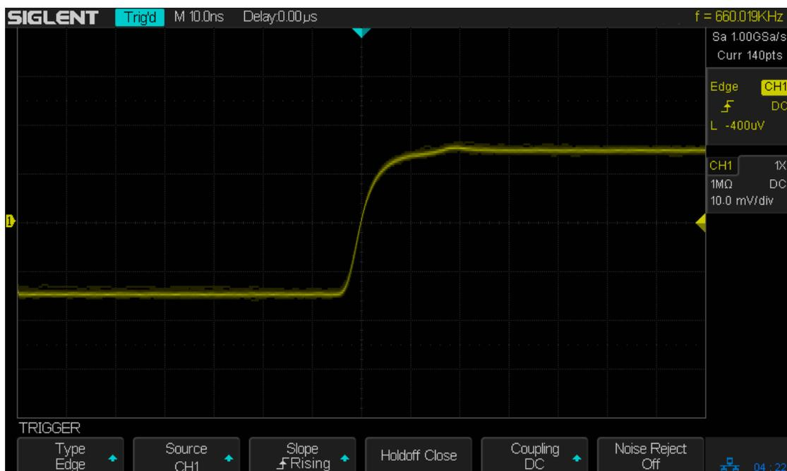
Figure 23 Edge Trigger
