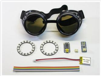
The kit version includes our costume goggles (http://adafru.it/e10), two NeoPixel rings (http://adafru.it/dyU), a Trinket microcontroller (http://adafru.it/dyV), JST connector (http://adafru.it/1769), rechargeable 150 mAh LiPoly battery (http://adafru.it/dYY), enough wire for all the connections, plus a USB battery charger (http://adafru.it/doR).
