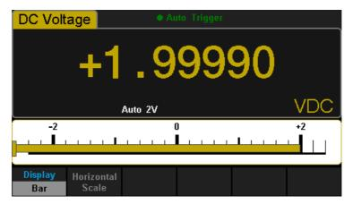
Diagram 2- 64 Bar Meter Display Mode
