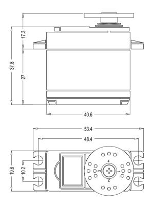
2.FEATURES 3-POLE FERRITE MOTOR **DUAL BALL BEARING** LONG LIFE POTENTIOMETER 3-METAL GEARS & 1-RESIN METAL GEAR HYBRID I.C
