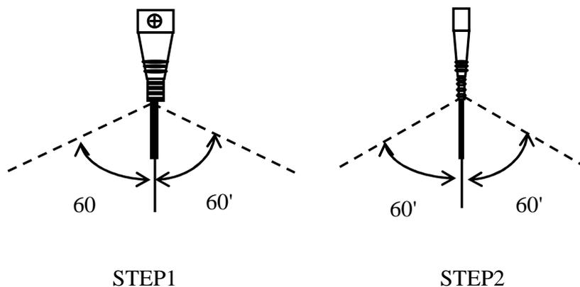
**D. CORD BENDING TEST OF ADAPTOR SIDE**
