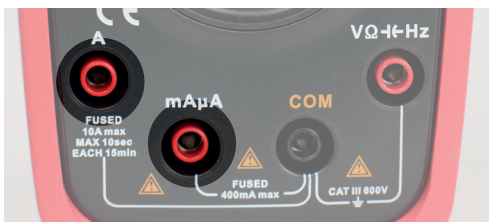
Ingångar för strömmätning
