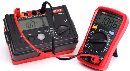
Mätning av voltmeterns inre resistans
