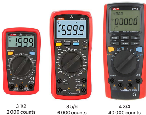
Tre instrument med olika skallängd
