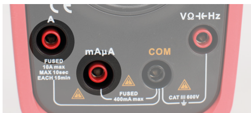
Ingångar för strömmätning
