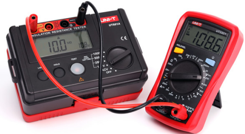
Mätning av voltmeters inre resistans
